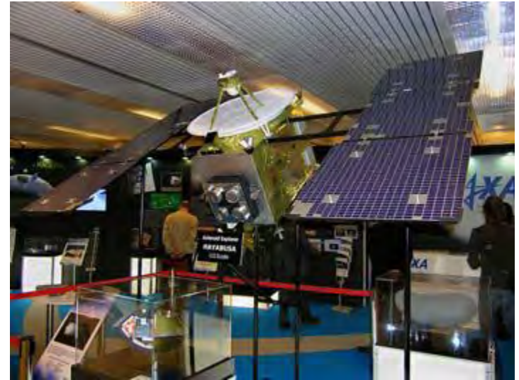
探査衛星はやぶさ 1m × 1.6m × 2m、約510kg
